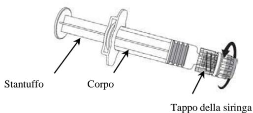
1. Tenendo il **corpo** della siringa in una mano (evitare di mantenere la siringa tenendo lo stantuffo), svitare il tappo della siringa ruotandolo in senso antiorario.
